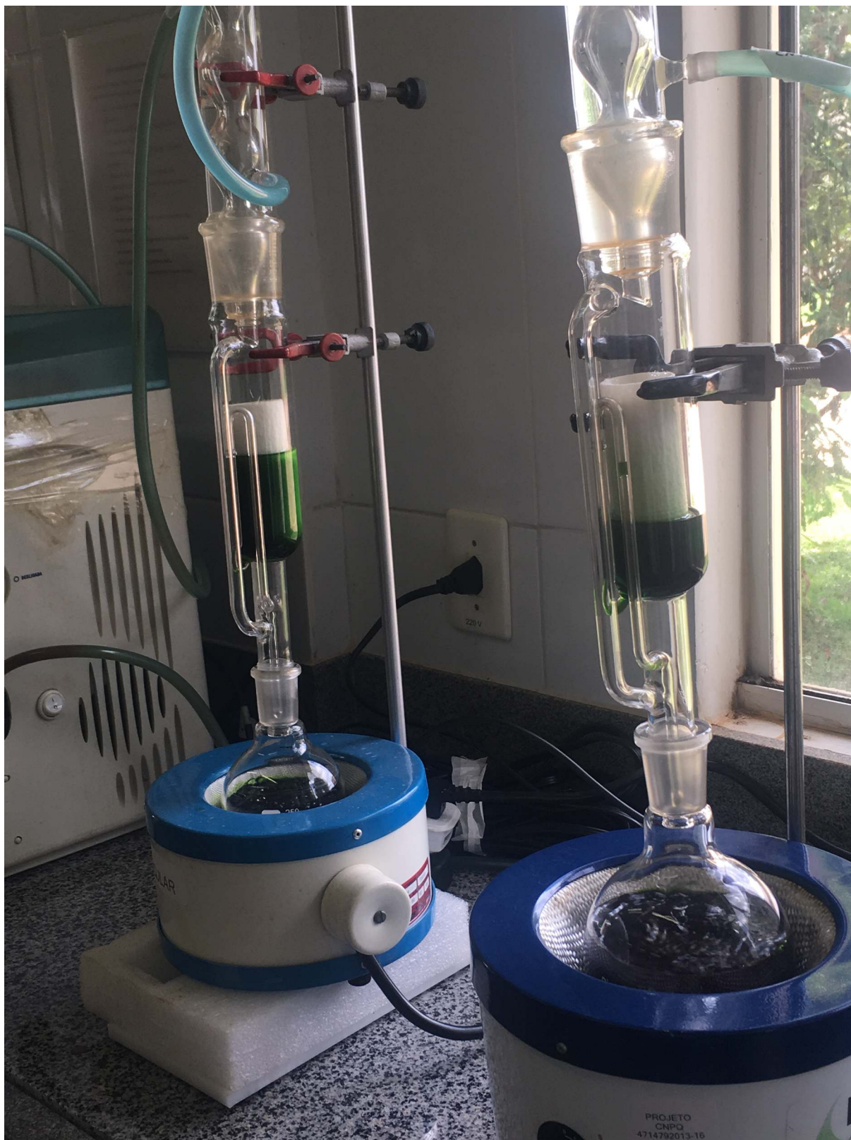
Figura 7: Processo de extração da Piper aduncum pelo método se Soxhlet.
