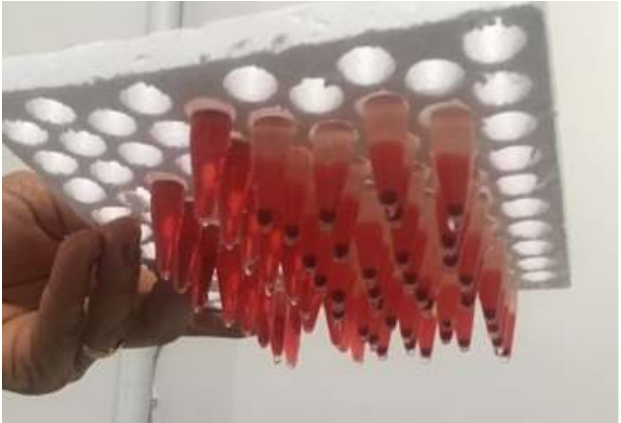
Figura 12: Teste de fragilidade osmótica eritrocitária. Amostras após incubação.
