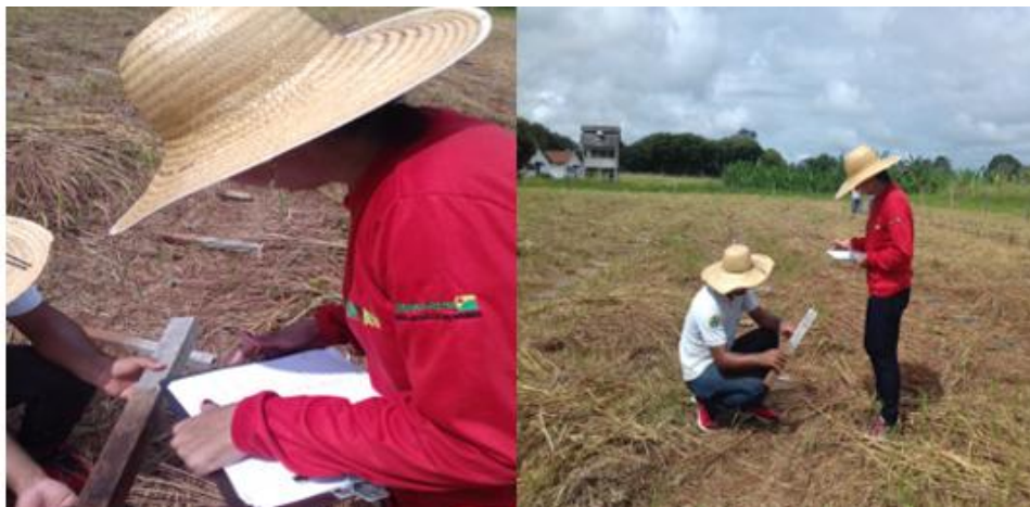
FIGURA 2 – Aspecto da avaliação de campo das estacas implantadas no campo de apodrecimento. Fonte: Autora
