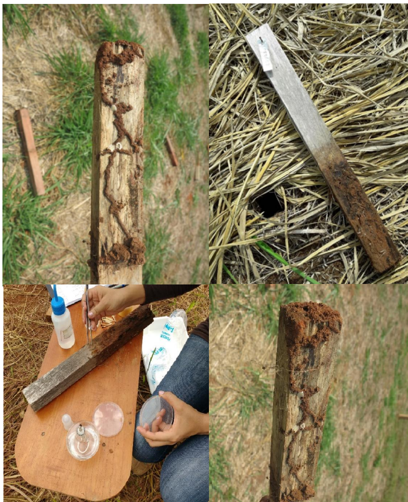
Figura 08 – Ocorrência de cupins em corpos de provas
