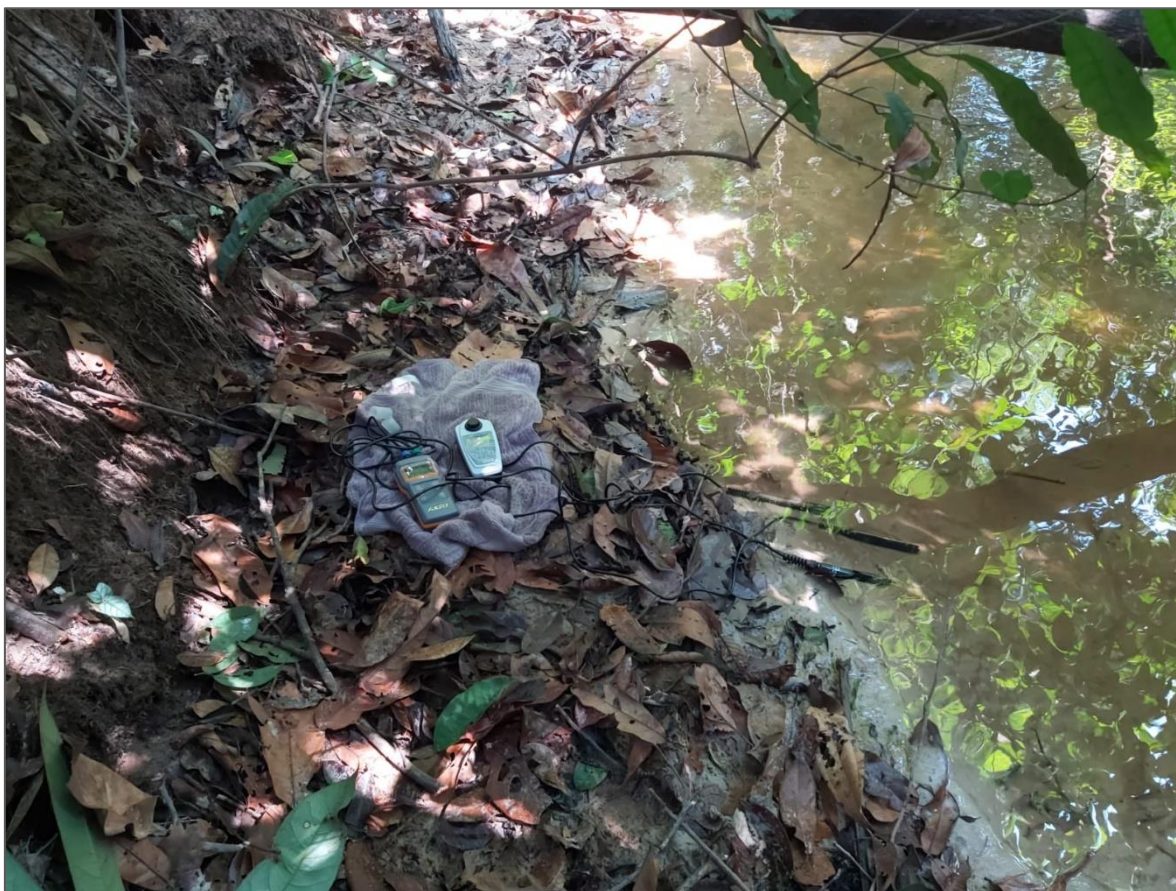
Figura 4. Fotografia dos equipamentos que foram utilizados e da medição dos parâmetros físico-químicos da água dos igarapés da ESEC Cuniã.
