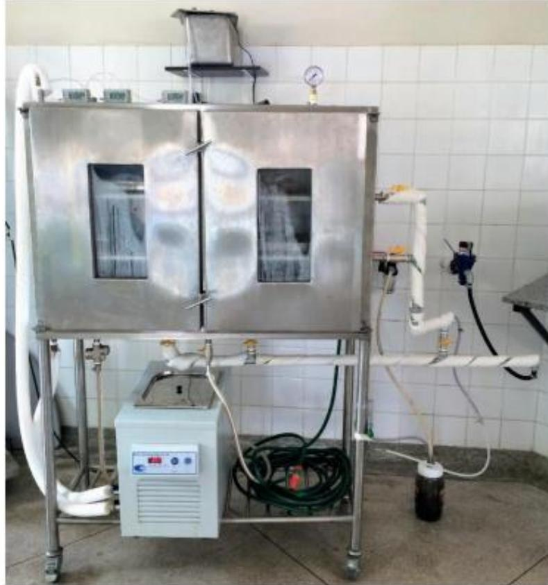
Figura 17 - Visão interna do biorreator de bandeja e seus periféricos
