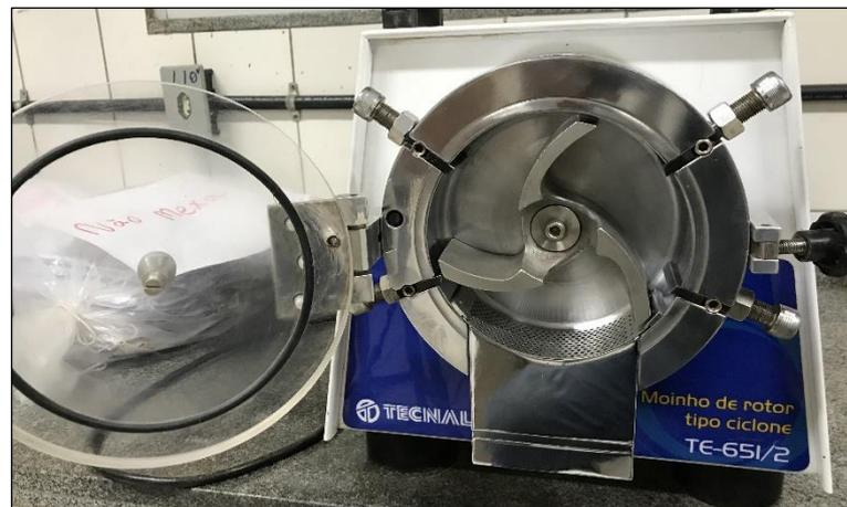
**Figura 5** – Moinho de Rotor tipo Ciclone TE-651/2, utilizado para triturar a matéria seca de colmos e folhas de bambu *Guadua* sp. nov.
