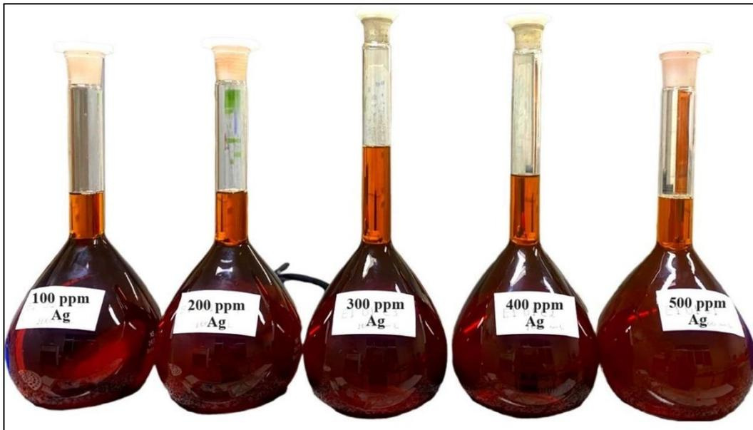
**Figura 18** – Solução com nanopartículas de prata (AgNPs) reduzidas a partir de  $2,00 \text{ g.L}^{-1}$  de extrato liofilizado de folhas de bambu *Guadua* sp. nov., nas concentrações de 100, 200, 300, 400 e 500 ppm de Ag.
