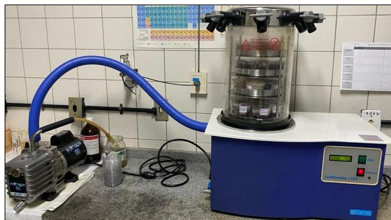
**Figura 9** – Aparelho liofilizador (Liofilizador L 101 da LIOTOP).
