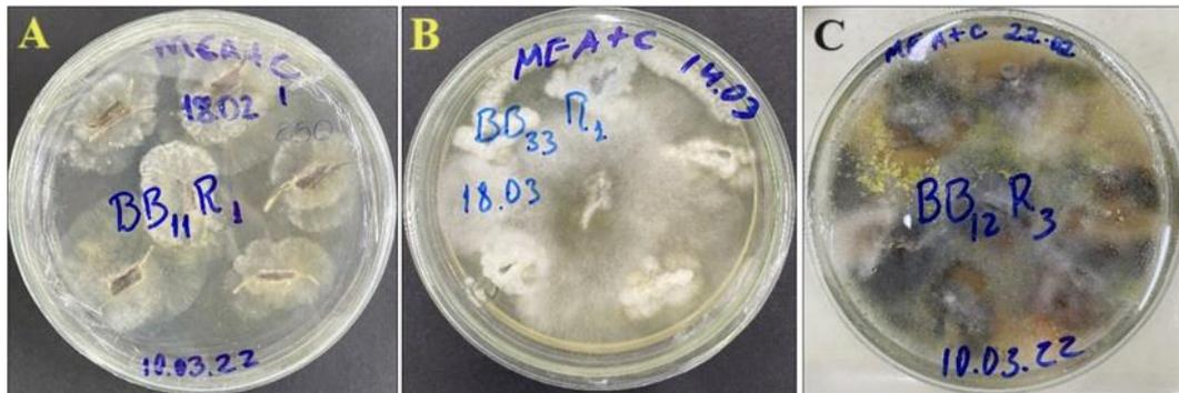
**Figura 15** – Presença de esporos de fungos nas placas de petri, após 3 dias (A), após 7 dias (B) e após 30 dias (C) da sementeira de fragmentos de bambu *Guadua* sp. nov.
