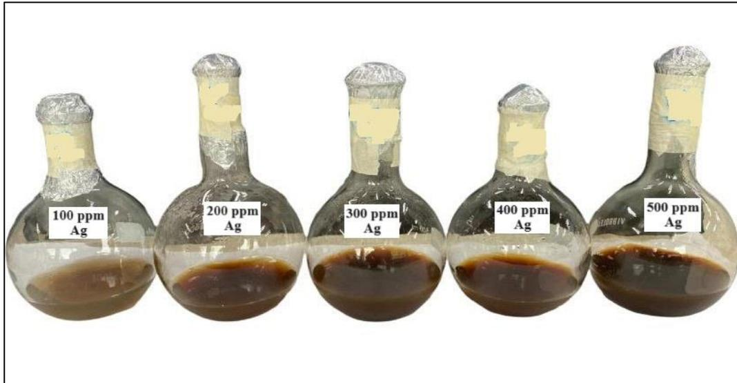
**Figura 19** – Solução contendo nanopartículas de prata (AgNPs) em diferentes concentrações de Ag, após esterilização em autoclave a 121°C durante 20 minutos.
