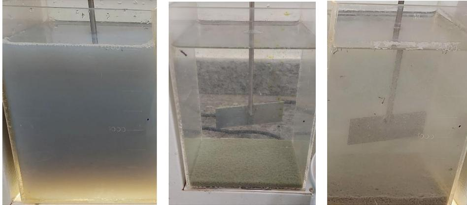
À esquerda o efluente bruto, no centro o efluente tratado com APA 15 mg.L<sup>-1</sup> e CF 200 mg.L<sup>-1</sup> e à direita o efluente tratado com 15 mg.L<sup>-1</sup> e CF 250 mg.L<sup>-1</sup>, ambos utilizando a adição simultânea.
