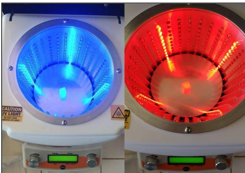
Figura 29. Irradiação das amostras com LED azul em 470 nm e LED vermelho em 624 nm.
