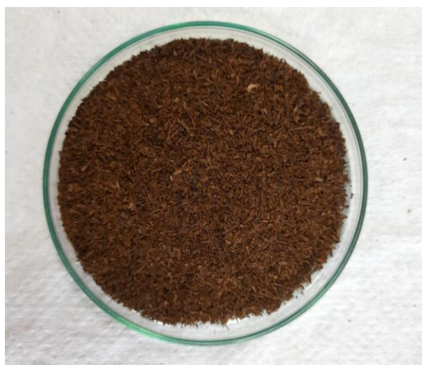
Figura 8. Hidrocarvão obtido no processo de carbonização hidrotérmica. Fonte: o autor.
