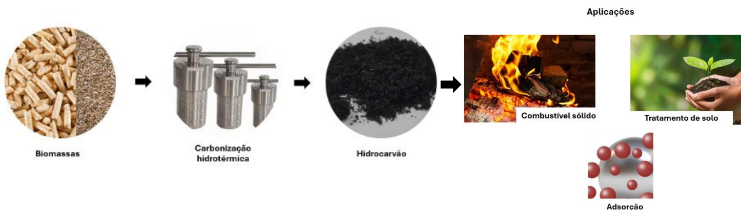
Figura 3. Potenciais aplicações do hidrocarvão produzido a partir de biomassas residuais.
