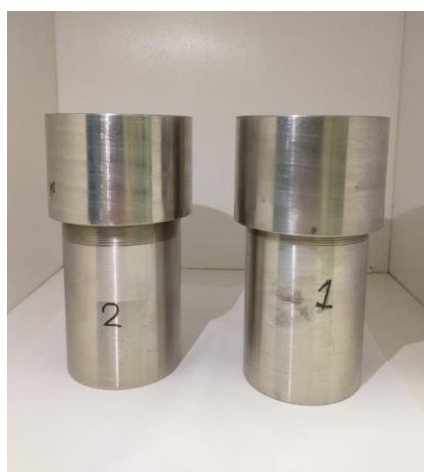
Figura 7. Reatores autoclaves utilizados no experimento. Fonte: o autor.
