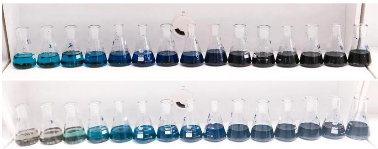
Figura 24. Fotos do antes e depois dos pontos experimentais da isoterma do carvão ativado. Fonte: o autor.
