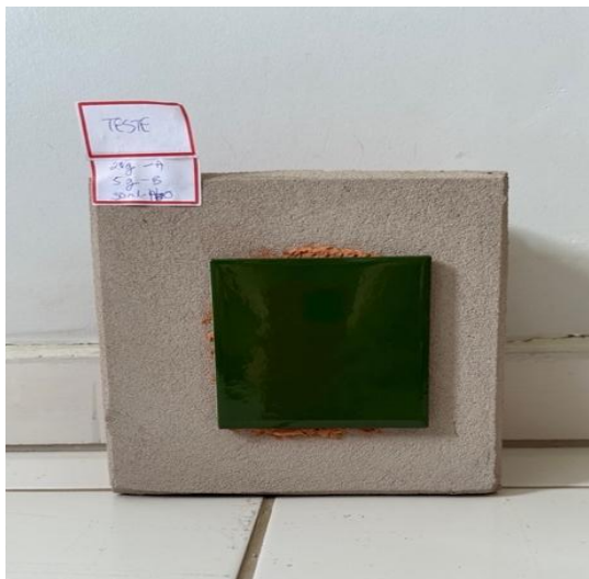
Figura 4 - Argamassa Geopolimix aplicada e seca no assentamento de lajota.
