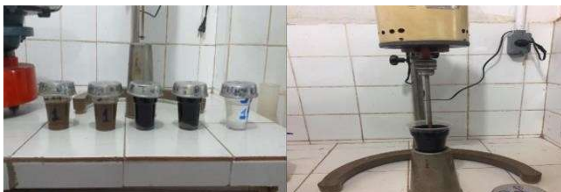
Figura 4(b) – Ataque Químico e Agitação das Amostra para análises físicas do Material.
