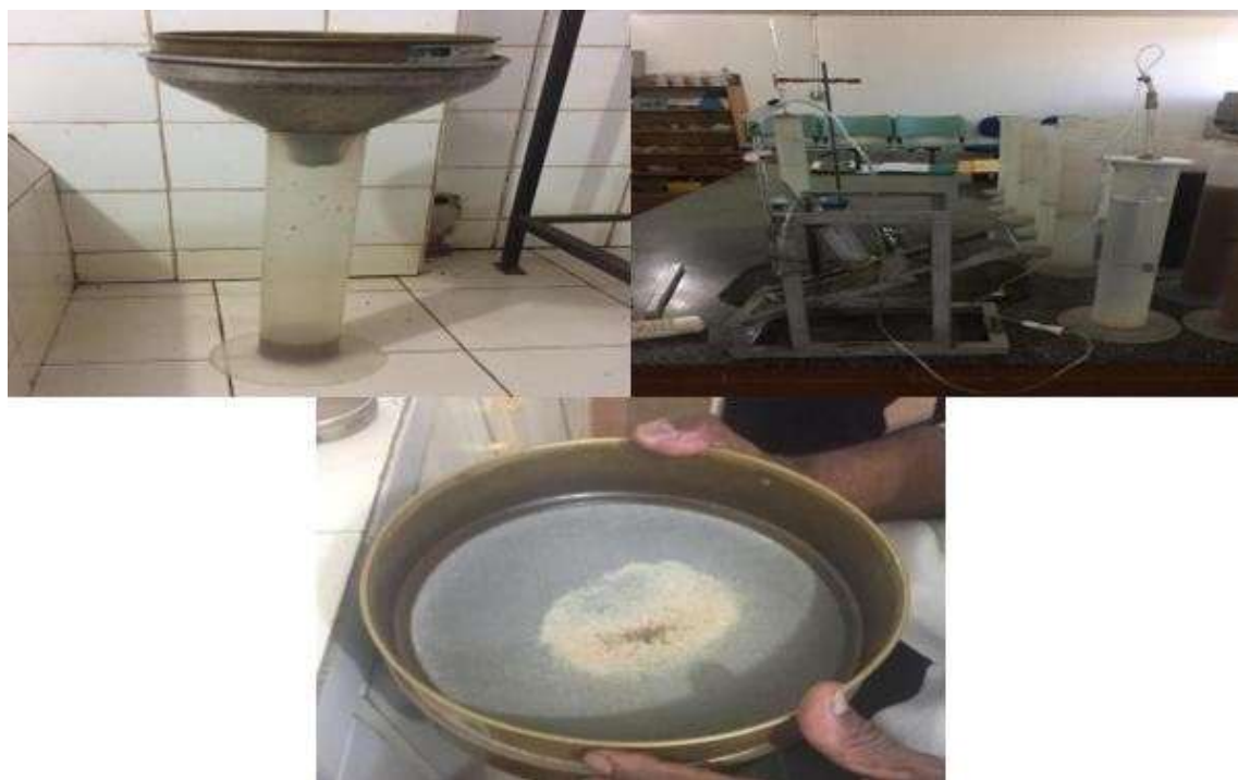
Figura 05 (b) – Lavagem de Material Retido na Peneira, Coleta através de Pipetador Automático, e Separação de Areia Grossa e Fina.
