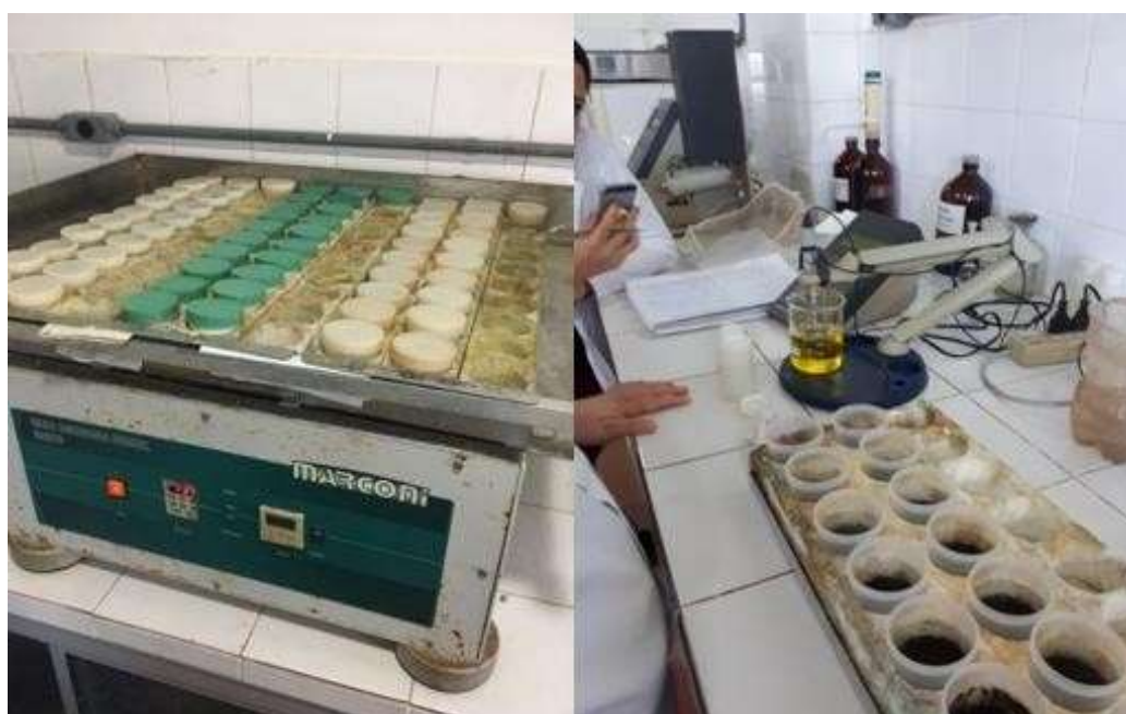
Figura 4(a) – Mesa Agitadora de Amostras, e Processo de Análise de pH.
