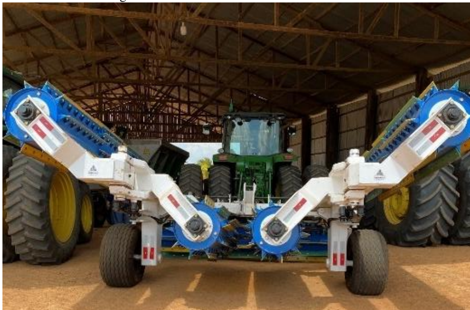
Fotografia 20 - Maquinário rolo-faca, utilizado para o controle de plantas infestantes em Tartarugalzinho
