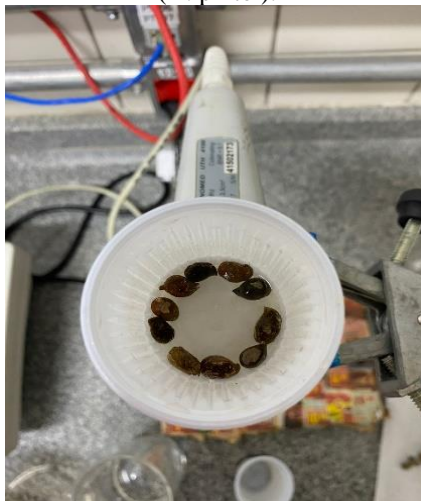
Figura 2. Aplicação de ultrassom de 1,0 W/cm 2 , com frequência de 1 MHz, em sementes de amendoim forrageiro (A. pintoi).
